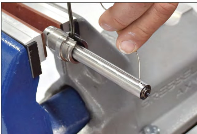
Abbildung 85: Thermofühler in die Bohrung der Düse stecken
