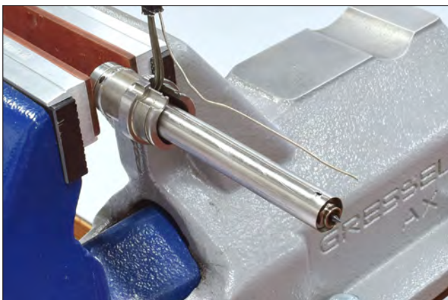
Abbildung 83: Defekten Thermofühler demontieren
