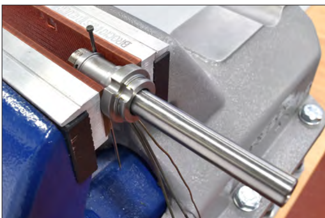
Abbildung 78: Vorzentrieren um die Spannhülsen zu montieren
