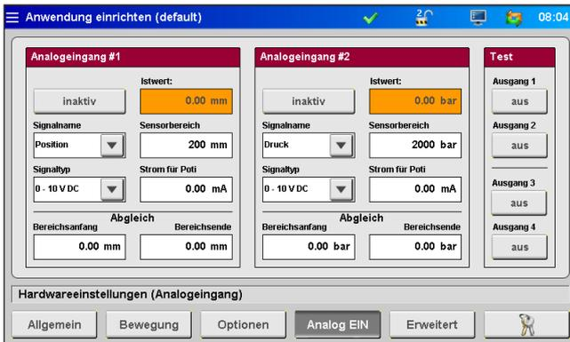
Abbildung 21: Ansicht "Hardwareeinstellungen (Analogeingang)"
