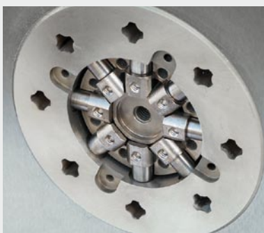
Blick auf den ungeteilten Formeinsatz mit eingebauter Düse und bereits montierten Spitzeneinsätzen.
