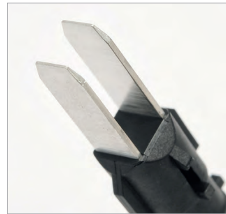
■ Die auf Rolle angelieferten Metallkontakte laufen im ersten Arbeitsschritt in eine Stanzstation, in der die Vereinzelung erfolgt (links). Die Anspritzung erfolgt 6-fach auf dem oberen der beiden Verbindungsstege (Mitte). Das fertige Bauteil muss höchsten maßlichen Ansprüchen genügen. Bei der Position der Kontaktschwerter (rechts) sind Abweichungen von höchstens 0,25 mm erlaubt.
